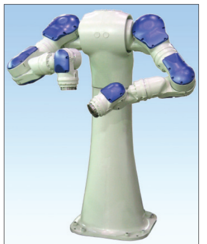
新型の双腕ロボット「MOTOMAN-SDA10」両腕で作業できる7軸制御の新型ロボット
